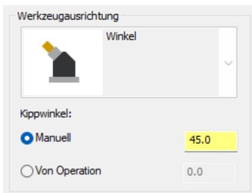
Winkelhöpfe können mit einem festen Winkel erstellt werden, oder Sie können sie so konfigurieren, dass sie die Winkelausrichtung aus der Operation erhalten. Dies wirkt sich darauf aus, wie Sie die Werkzeugebene einstellen.
